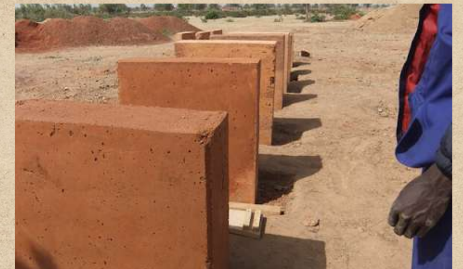
Amostras de blocos de argila e construção de uma parede de adobe. Fotos de Francis Kéré
